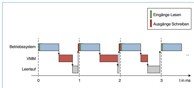
In jedem 1 ms-Zyklus werden zuerst die Daten aus dem Objektverzeichnis ausgelesen, das als zentrale Datenbasis alle Einstellungen und Zustandswerte des Reglers enthält. Anschließend läuft das „Betriebssystem“, also z.B. die übergeordneten Funktionen des Motorreglers und die Feldbuskommunikation.
