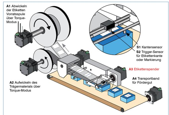
Im Folgenden werden wir in zwei Schritten ein einfaches Programm entwerfen, das die Funktion eines Etikettenspenders abbildet.
